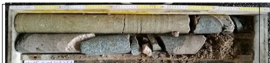
Obr. č. 4 - diagnostický vrt K1 - kamenná klenba
