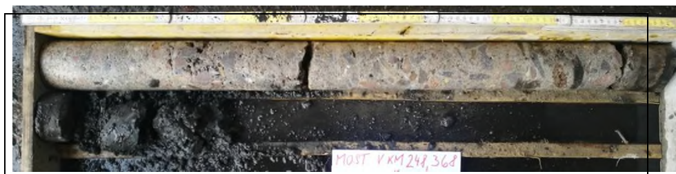
Obr. č. 7 - diagnostický vrt K2 - betonová klenba
