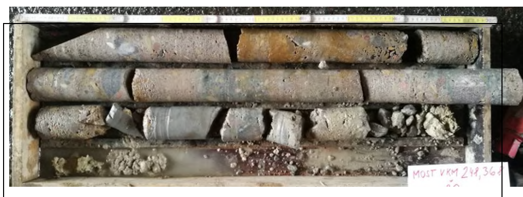
Obr. č. 6 - diagnostický vrt Š2 - opěra Ústí n. O.
