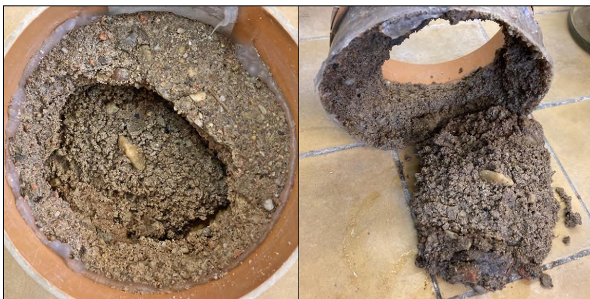
Foto 3: Líc (vlevo) a celý vzorek (vpravo) vzorku CHRL1 po zkoušce – 75 cyklů Zaznamenán celkový rozpad zkušebního tělesa
