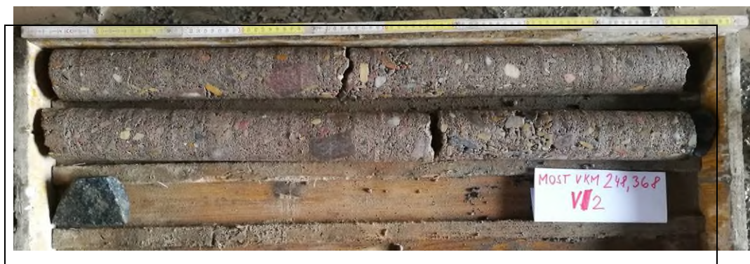
Obr. č. 5 - diagnostický vrt V2 - opěra Ústí n. O.
