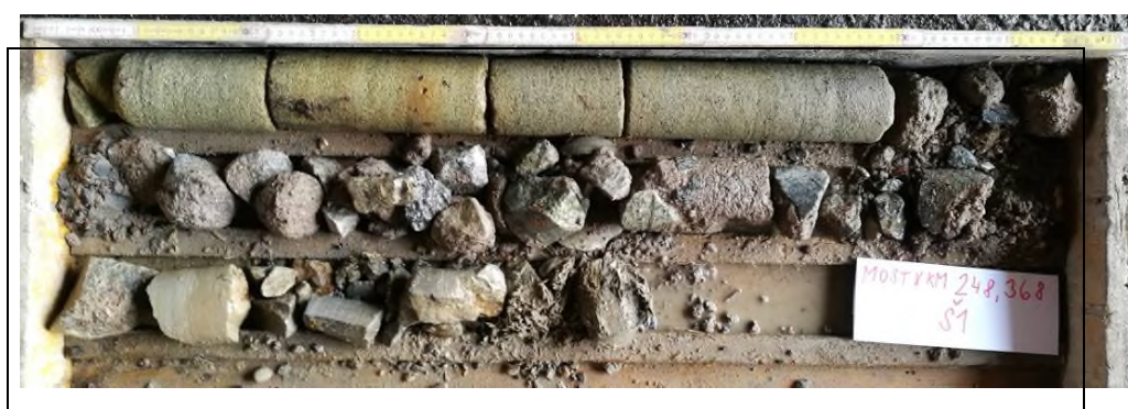
Obr. č. 2 - diagnostický vrt Š1 - opěra Č. Třebová
