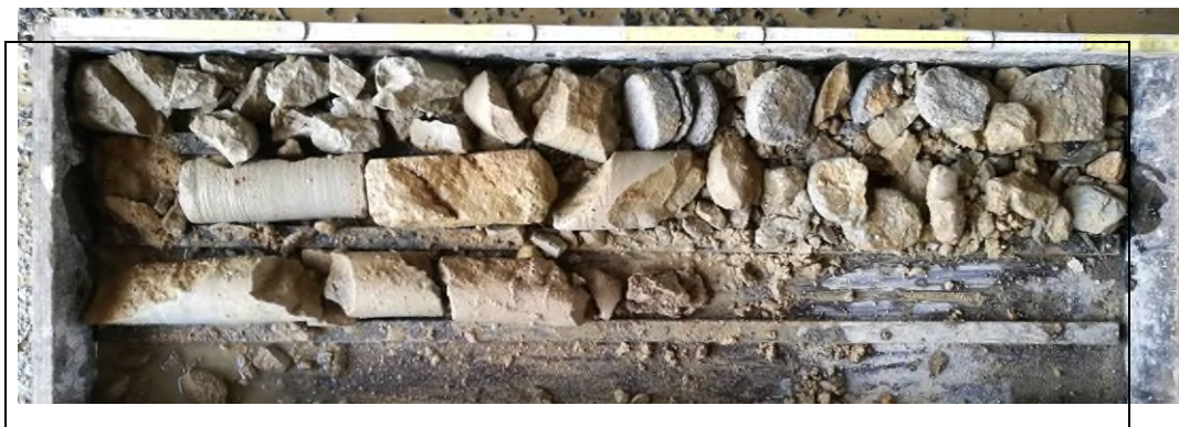
Obr. č. 1 - diagnostický vrt V1 - opěra Č. Třebová
